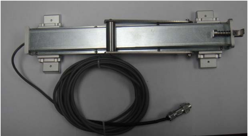
a) 位移传感器安装到支座
