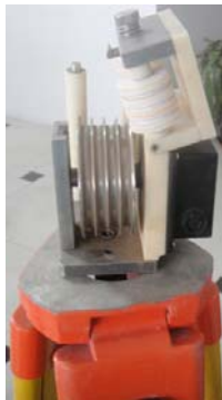
图 4.1.2 深度记录装置安装
