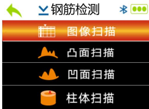
图 4.3 钢筋检测界面
